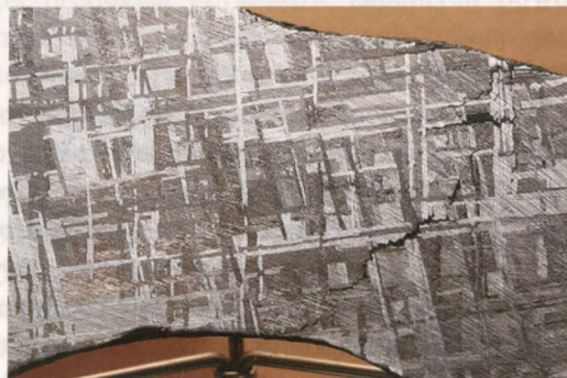
Ryc. 3. Budowa wewnętrzna meteorytu żelaznego Gibeon, widoczne struktury Widmanstatten.
