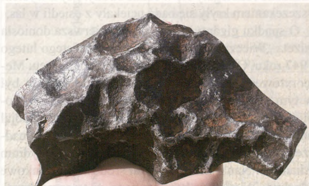
Ryc. 2. Fragment meteorytu żelaznego Gibeon, widoczne na powierzchni regmaglipty.
