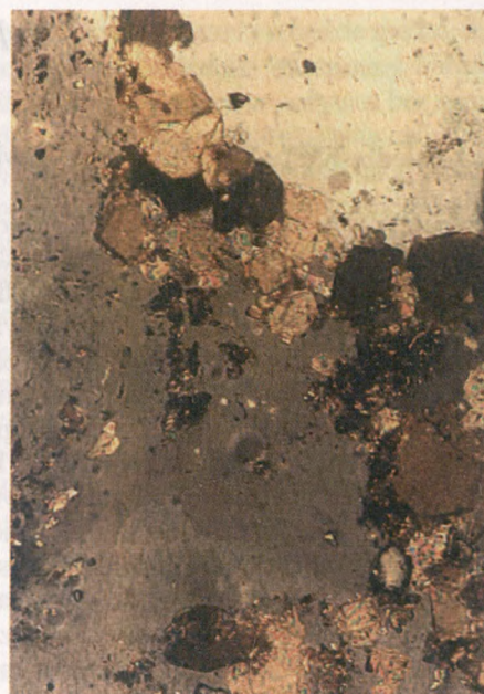
Ryc. 6. Obraz mikroskopowy gipsu grubokrystalicznego, szarego. Widoczna intensywna impregnacja minerałami ilastymi. NX, pow. 100 x
