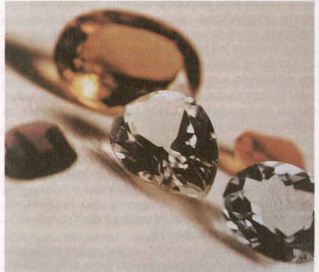
Ryc. 1. Obróbka wysoko temperaturowa i pod wysokim ciśnieniem diamentów może zmienić niepożądane brązowe kamienie w bardziej wartościowe bezbarwne lub fantazyjne zabarwione kamienie szlachetne (źródło: Materials Today, vol. 3, Issue 3, 2000, s. 1)
