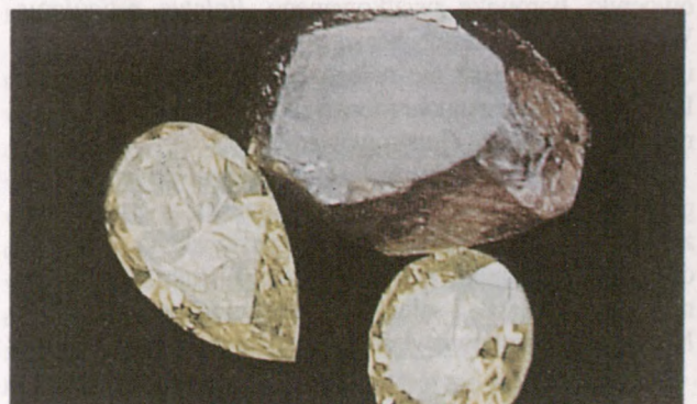
Ryc. 3. Brązowy diament przed obróbką i dwa żółto-zielone fasetowane diamenty, które zostały wyszlifowane z brązowych diamentów po obróbce (źródło: Materials Today, vol. 3, Issue 3, 2000, s. 4)
