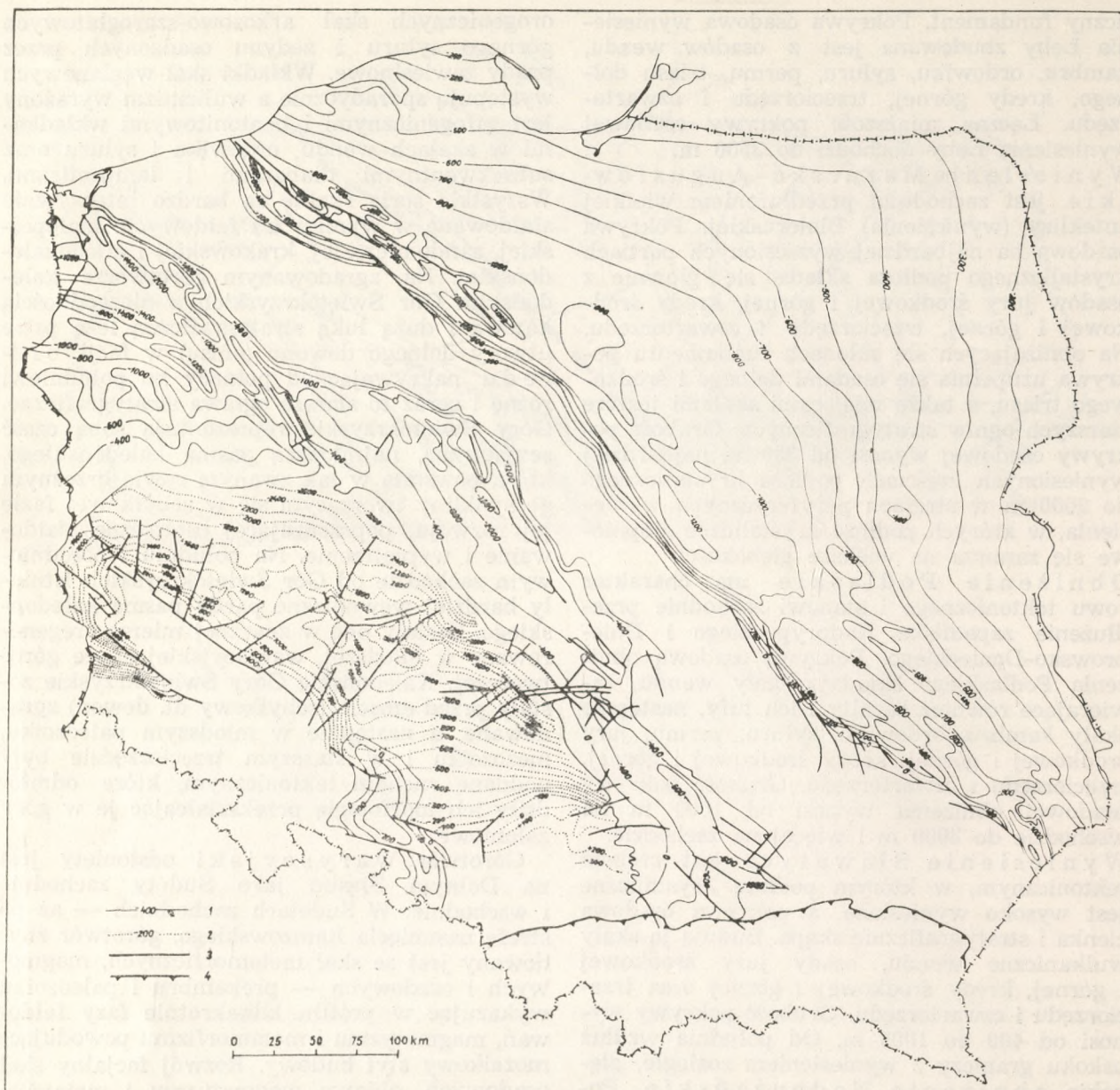
Ryc. 3. Mapa układu strukturalnego pokrywy osadowej wg spągu kredy górnej, a na obszarze przedsudeckim wg spągu węglanowego triasu (kreda wg M. Jaskowiak-Schoeneich, trias wg Z. Śliwińskiego; zmodyfikowane): 1 — izohipsy spągu kredy górnej, 2 — izohipsy spągu węglanowego triasu, 3 — ważniejsze uskoki, 4 — granica nasunięcia karpacckiego
