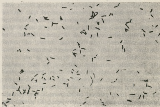
Ryc. 2. Pałeczki Desulfovibrio desulfuricans stanowią pospolity przykład bakterii redukujących siarczany, które wywołują niezwykle ciężkie objawy beztlenowej korozji żelaza i stali
