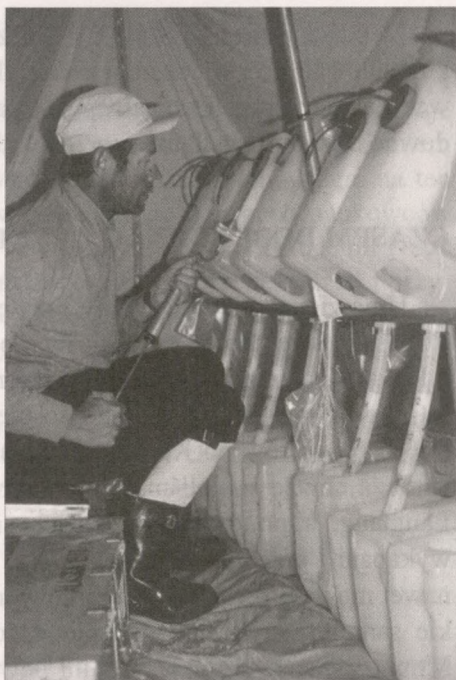
Namiet-laboratorium na lodowcu Cherku. W. Maczek pompuje powietrze do butli ze stopionym lodem Fot. Z. Jaworowski
