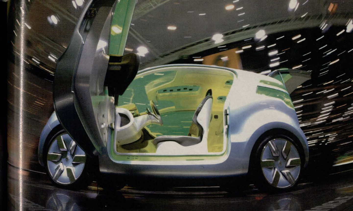
Diody LED zamiast energochłonnych reflektorów, kamery w miejscu wystających lusterek – „minimum strat” to motto elektrycznego Renault Z.E. (skrót od Zero Emission). Francuzi z produkcją czekają już tylko na stacje, w których będzie można „zatankować” prądem litowo-jonowe baterie auta
