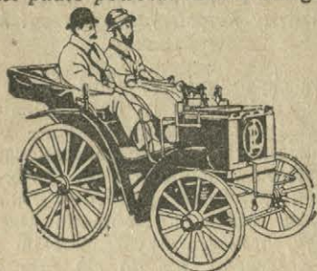
Typ pierwotny automobilu otwartego z r. 1893, który kształtem nadsługuje pojazd konny t. zw. fajeton.
