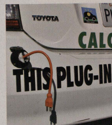
California Cars Initiative to zespół zapaleńców chcących stworzyć idealny ekosamochód. Oto przerobiona przez nich toyota prius, której akumulatory ładuje się prądem z domowego kontaktu
