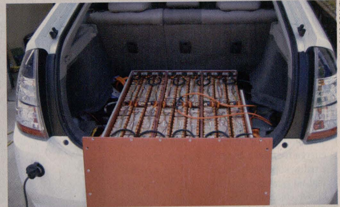
California Cars Initiative to zespół zapaleńców chcących stworzyć idealny ekosamochód. Oto przerobiona przez nich toyota prius, której akumulatory ładuje się prądem z domowego kontaktu
