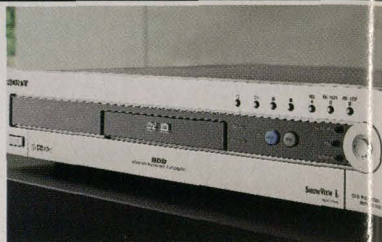
Choć wygląda jak zwykły odtwarzacz DVD, cyfrowy magnetowid ma wewnątrz twardy dysk o dużej pojemności, który pozwala na nagrywanie bez przerwy nawet przez dwa tygodnie. W dodatku jego zaprogramowanie jest znacznie prostsze niż w przypadku klasycznego magnetowidu
