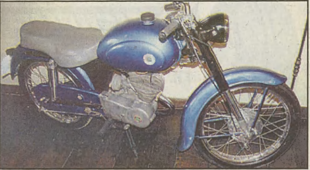
Jednocylindrowa, dwusuwowa OSSA (z lat sześćdziesiątych) o pojemności skokowej 150 cm³; miała 3 biegi, ważyła 90 kg i rozwijała 90 km/godz.
