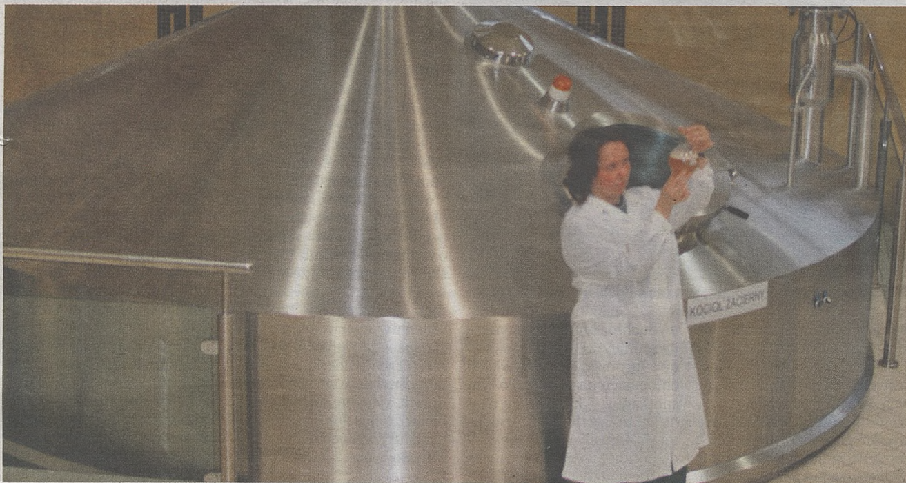
Pierwszym etapem produkcji piwa jest proces warzenia. Rozdrobniony słód z dodatkiem wody poddawany jest procesowi zacierania polegającemu na stopniowym podgrzewaniu. Po przefiltrowaniu zacieru powstaje brzeczka piwna, która gotowana jest z dodatkiem chmielu
