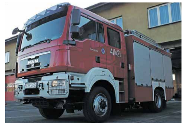
Przekazany samochód typu GBA 2,5/25 to pojazd na podwoziu MAN TGM 13.280 i napędzie 4x4.
