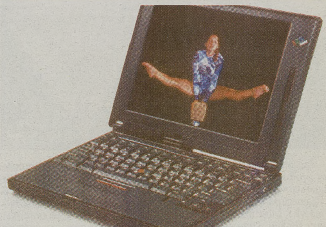
Najnowszy cienki (3 cm) i lekki (2 kg) notebook ThinkPad 560 firmy IBM. Model ten może również poszczycić się stosunkowo dużym kolorowym wyświetlaczem – 12 cali. (PAP/EPA)
