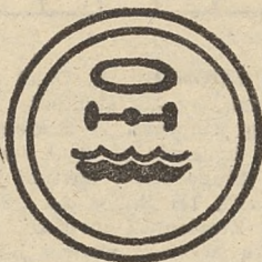
Zakaz wjazdu pojazdów z ładunkami, które mogą skażać wodę.
