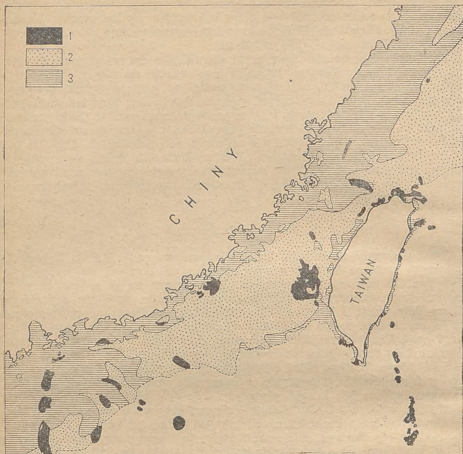
Rys. 3. Rozmieszczenie osadów na szelfie chińskim wg Sheparda: 1 — skaliste dno; 2 — piaski; 3 — muły i iły.
