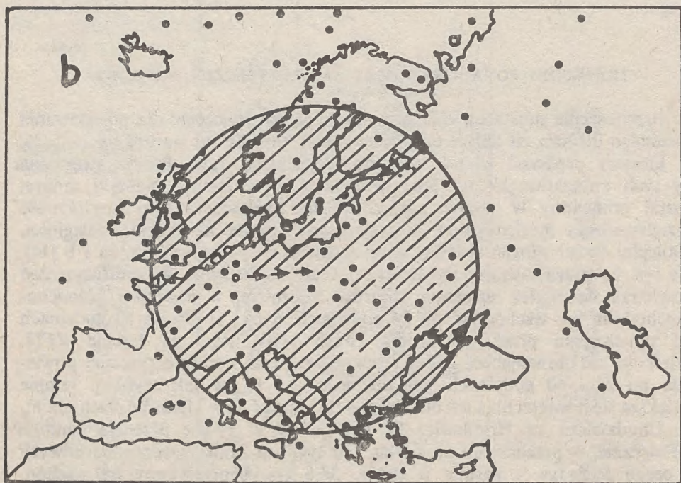
Rys. 5. Przenoszenie zanieczyszczeń powietrza przez wiatr. Pozycje teoretycznie przyjętych „porcji powietrza” po 24 godzinach (a), po 60 godzinach (b), które jak się przyjmuje zostały wypuszczone w RFN. Obliczeń dokonywano co 3 dni w ciągu roku. Duże koło nakreślono wokół średniej pozycji wszystkich punktów i obejmuje ich 50%. Rodhe za [14]
