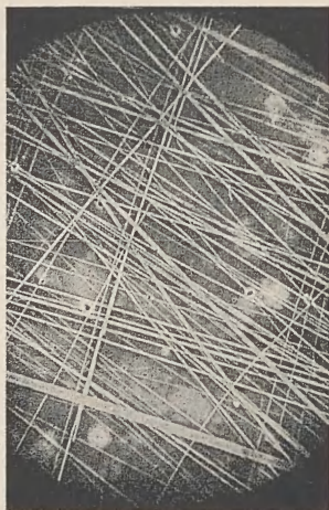
Rys. 2 Rysy w warstewce szkła wodnego wypełnione olejkim cedrowym: a) kontrast anoptralny, obiektyw 10x/0,24; b) kontrast fazowy, obiektyw 10x/0,25; c) jasne pole, maksymalnie przymknięta przysłona irysowa, obiektyw 10x/0,25.
