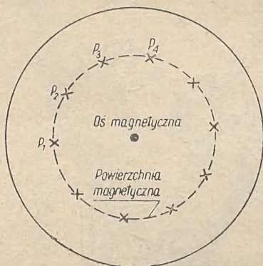
Rys. 2. Przekrój rury stellatora z zaznaczonymi punktami P_1, P_2, \dots przez które przechodzi cząstka naładowana po kolejnym obiegu torusa stellatora w przypadku istnienia powierzchni magnetycznej (linia przerywana).
