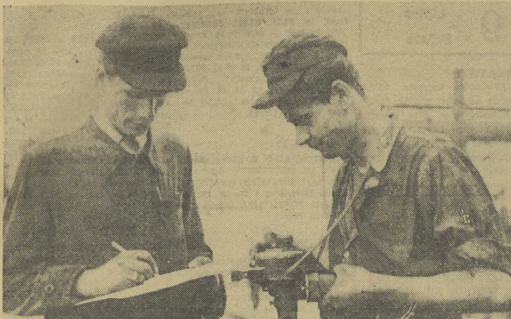
Jan Wiśniewski i Władysław Tajchma badają temperaturę komory pieca koksowniczego przy pomocy pirometru.
