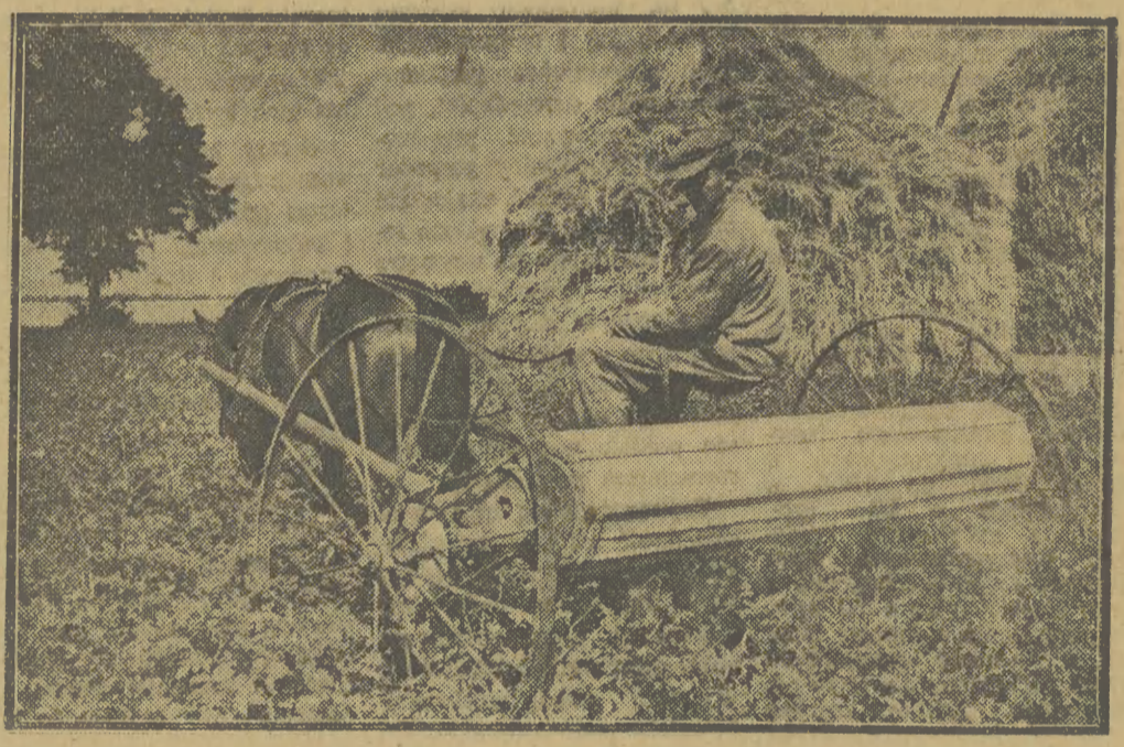
Józef Peksa, instruktor ochrony roślin w Prezydium Powiatowej Rady Narodowej w Szamotłach, konstruuje aparat do opylania roślin preparatami owadobójczymi. Pomyślnie polega na dorobieniu do konnej grabki, po uprzednim odjęciu grabi, łębna z listewek obitego futra workową. Na zdjęciu: opylanie pól ziemniaczanych środkami zwalczającymi stonkę, za pomocą nowego aparatu, w PGR Galowia. CAF — fot. A. Piwoński.
