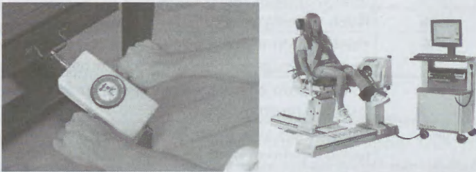
Ryc. 10. Dynamometr dłoniowy typu „pchaj-ciągnij” oraz sprzęt pomiarowy Biodex system4
